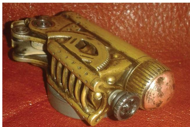
Осталось закрыть пружину. Устанавливаю «радиатор», он же контейнер для запасных кремней. Две крайние трубки заполняются кремнями, верхней частью одеваются на шпильки, а снизу радиатор фиксируется тем же винтом-«вентилем», который прижимает кремень.
