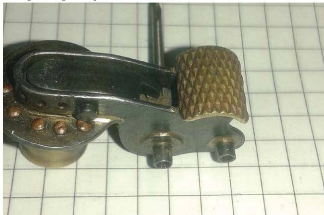
Устанавливаю кресало на место и затягиваю ось. Чтобы шлиц не царапал и не цеплялся, он закруглен с концов и почти полностью утоплен в подшипник.
