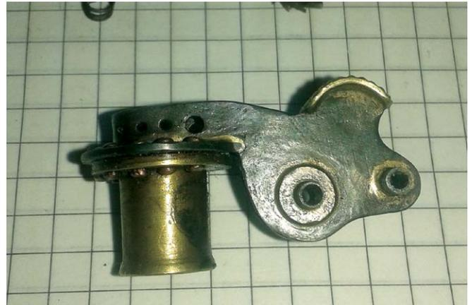
Приступаю к финальной сборке. На крышку одевается толкатель (шатун) и впрессовываются подшипники (7x3).
