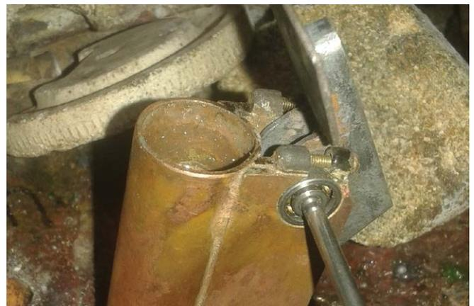
Крышка сажается в корпус через прорези, на оси одеваю подшипники и затягиваю.
