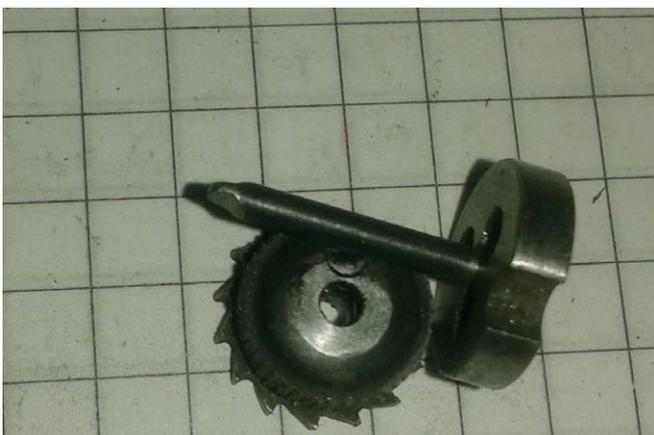
крышки, поэтому решил сделать ее из хвостовика сверла 2мм. Отпустил сверло (насколько было возможно) и нарезал резьбу М2.
