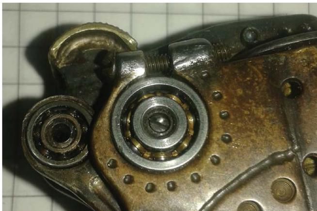
Устанавливаю шату кремня, она же направляющая для пружины и шатуна. Шатун в нижней части качается на упорной шайбе.
