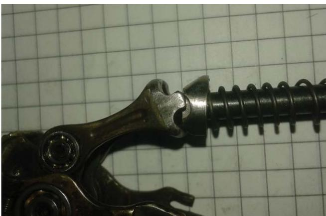
Ось кресала проходит внутри оси крышки. Она не очень сильно нагружена, но она поддерживает полую ось
