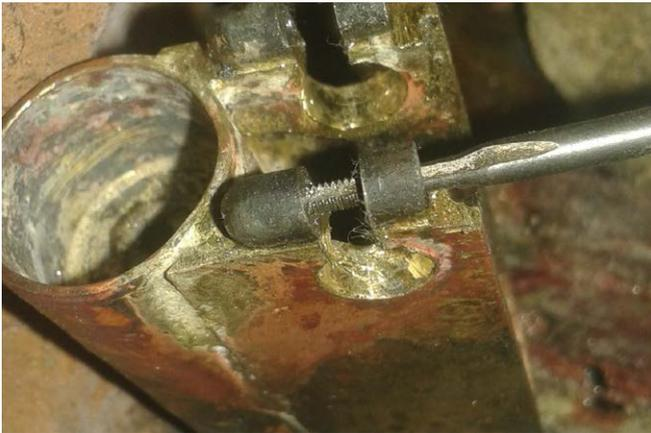
Спаял корпус: латунная трубка 19 мм, рамка из листа 2 мм, место посадки подшипника усилил, сверху припаял втулки для стяжных болтов, просверлил в рамке отверстия для подшипников и разрезал.
