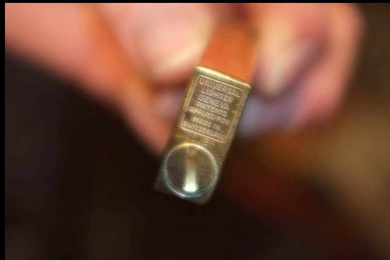
Это зажигалка из тех, что рядовому зажигальщику за всю карьеру можно и не увидеть ни разу — швейцарская «Юниверсал», колёсико на задней стенке служит для поднятия фитиля...
